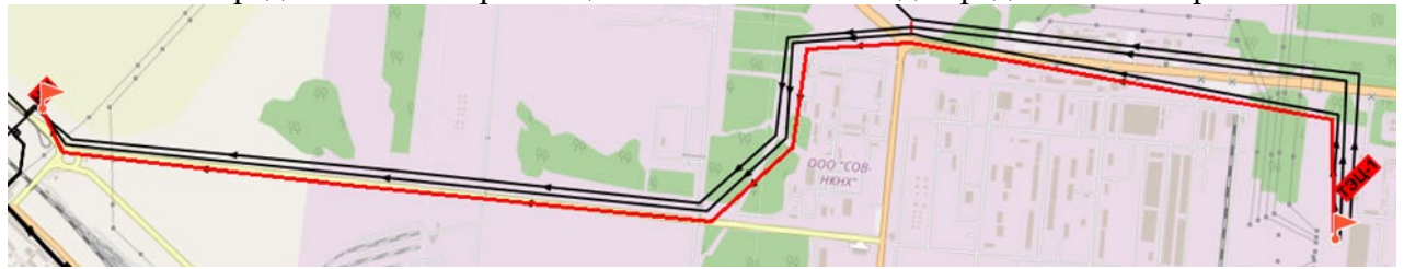
Рис. 2.10. Предполагаемое размещение нового тепловода dy1000
